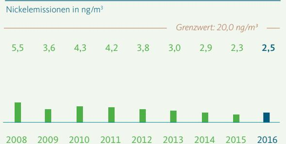
Die Messungen der Luftqualität für Schwebstaub und Inhaltsstoffe zeigen eine deutliche und durchgängige Unterschreitung, sowohl der Grenzwerte für PM<sub>10</sub> und Blei als auch der EU-Zielwerte für Arsen, Cadmium und Nickel. Zum Vergleich ist auch die LANUV-Messstelle Niederaden aufgeführt, die für das LANUV als Nullpunktmessstelle ohne industrielle Beeinflussung fungiert.
