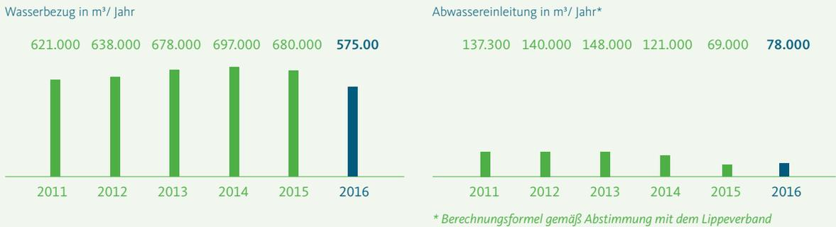
ein großer Teil des werksinternen Kühl- und Brauchwasserbedarfs über das gesammelte Regenwasser abgedeckt werden, sodass die Einleitmengen und auch der Wasserbezug zurückgehen werden.
