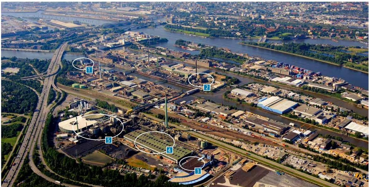
1 Stranggussanlage 2 Sekundärhütte/Edelmetalle 3 Rodanlage 4 Elektrolyse 5 Rohhütte Ost
